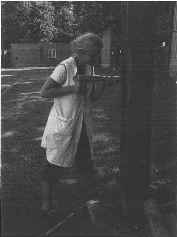
Rys. 9. Badanie stanu zachowania drewna przy użyciu pilodynu typu 6J-Forest (Fot. W. Kokociński)
