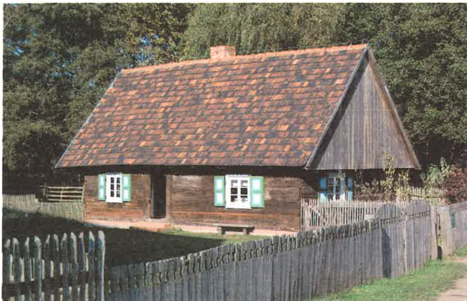
Fot. 2. Chałupa (1823 r.) szerokofrontowa symetryczna, konstrukcji zrębowej, przeniesiona z Nowego Tomysła, fot. Z. Wielgosz 2003 r.
