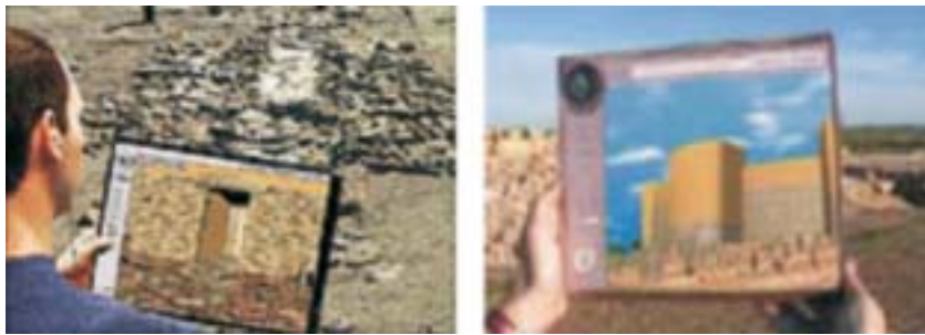
Rys. 64. Els Vilars, system prezentacji wizualnej Augmented Reality korzystający z wyświetlacza ciekłokrystalicznego jako interfejsu użytkownika. Research Group on Human-Computer Interaction and Databases University of Lleida. (za D.H. Sandersem)
