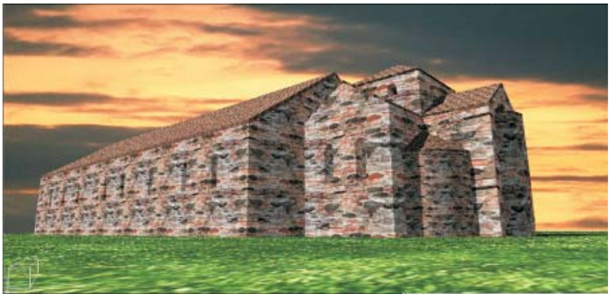
Rys. 79 (A,B,C). Wizualizacje modelu trójwymiarowego wykonanego według hipotezy rekonstrukcyjnej K. Żurowskiej (opracował autor)
