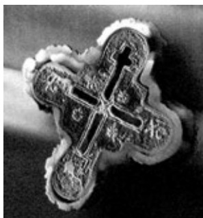
Ryc. 8. Amplitudogram uzyskany z analizy częstotliwościowej 1000 obrazów dla składowej podstawowej o częstotliwości ok. 3mHz
