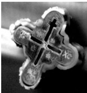
Ryc. 9. Amplitudogram uzyskany z analizy częstotliwościowej 1000 obrazów dla składowej podstawowej o częstotliwości ok. 3mHz, wersja po filtracji redukującej szumy
