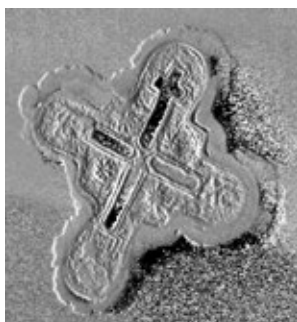
Ryc. 10. Fazogram uzyskany z analizy częstotliwościowej 1000 obrazów dla składowej podstawowej o częstotliwości ok. 3mHz
