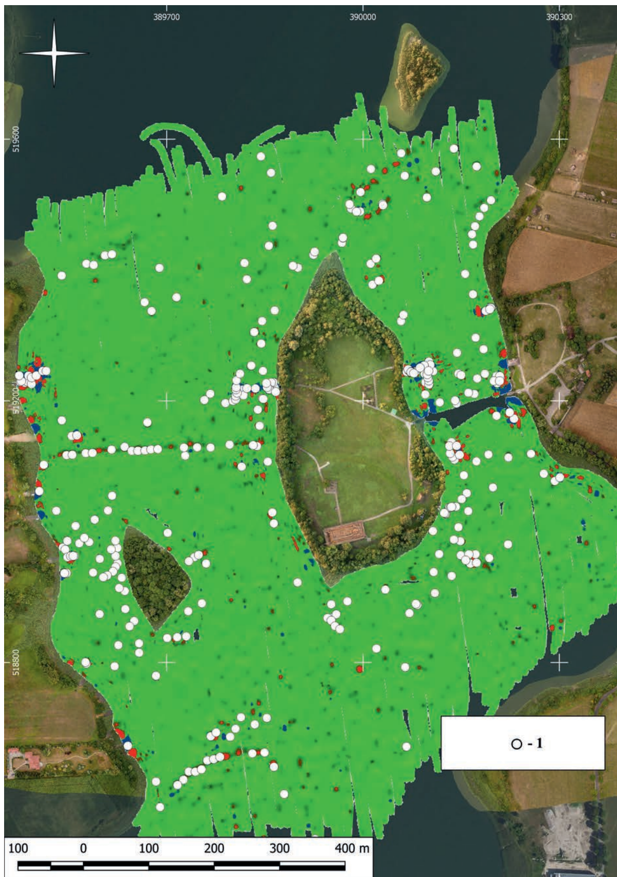
Ryc. 3. Mapa rastrowa wybranego obszaru jeziora Lednica z anomaliami magnetycznymi i potencjalnymi obiektami ferromagnetycznymi. 1 – anomalie magnetyczne. Oprac. M. Popek
