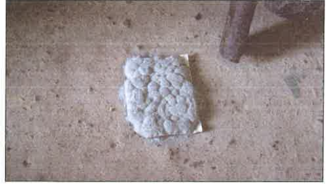
Il. 30. Produkt rozkładu po fumigacji fosforowodorem – Muzeum Wsi Słowińskiej w Klukach, fot. W. Pszczoliński.
